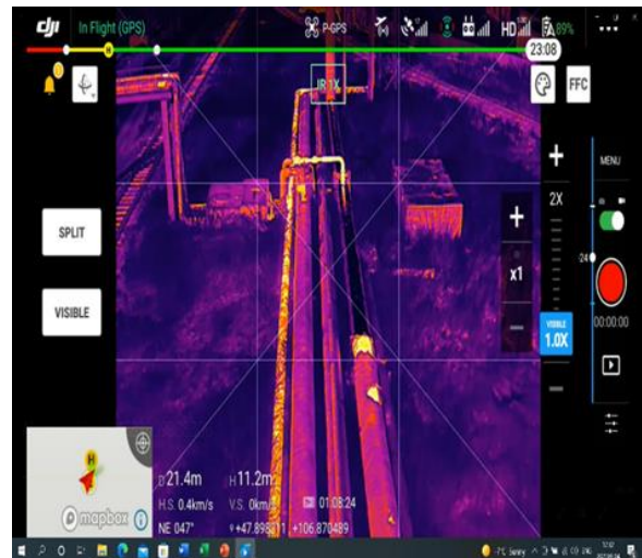
Зураг 4. Шугамын дулаалга хэсэг газарт хуурч унасан төлөв байдлын зураглал
