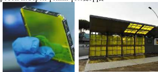
4-р зураг. а) Шар люминесцент будгаар полимерт допинг хийн гарган авсан LSC хавтан; хүрээгээр нь нарны зайн үүсгүүр суурилуулсан; б) Италийн Ром хотод байрлах ENI судалгааны төвийн гадна байрлах, LSC хавтан суурилуулсан дугуйн зогсоол.
