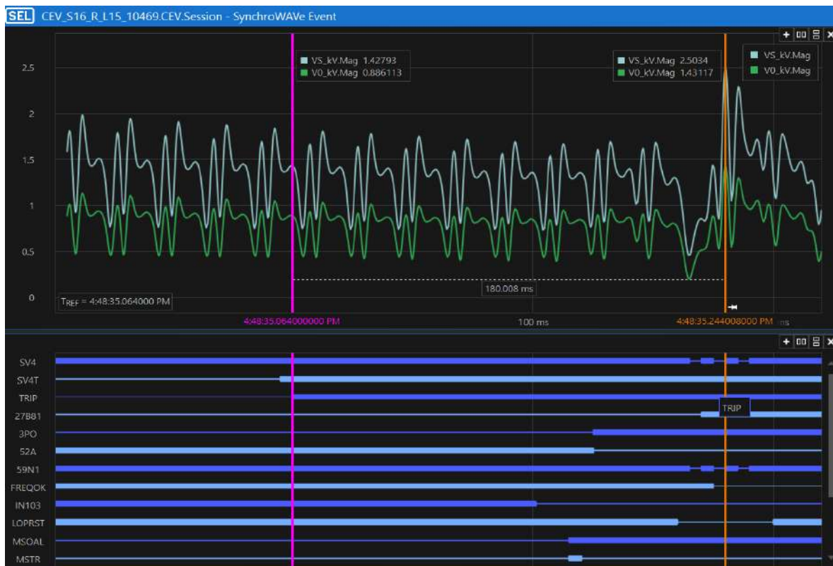
3-р зураг. SEL 351A релен дээрх 35 кВ-ын Т-2 оролтын тасралтын бичлэг
