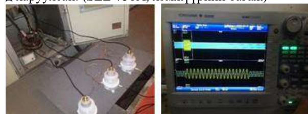
7-р зураг. Туршилтын схемийн холболт, осциллографын үр дүн.
