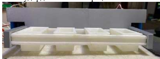
12-р зураг. 3D printer хэвлэж ажиллуулав. (Формыг хавчсан байдал)
