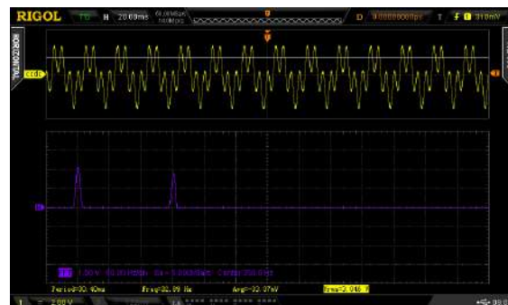
13-р зураг. RIGOL осциллограф ашиглан 50 Гц болон 200 Гц давтамж бүхий сигналуудын нийлбэр сигналыг ФХХ ашиглаж спектрийн анализ хийсэн байдал (Цонх ашиглаагүй)
