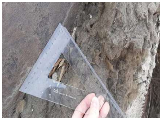
3.5-р зураг. Одоо байгаа дулаалгын зузааныг хэмжиж буй байдал
