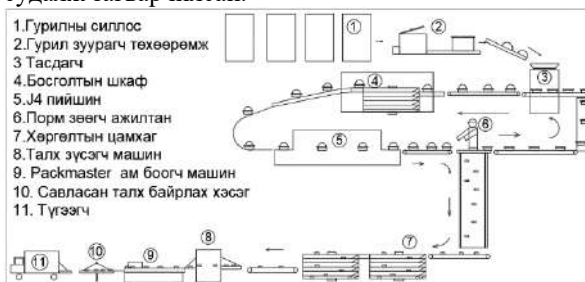
1-р зураг. Технологийн процессын бүдүүвч зураг. (Үйлдвэрийн ургац шугамын ажиллах процесс)
