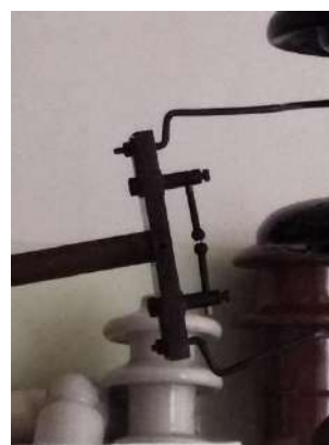
2-р зураг. Бөмбөлгөн очлуур. (бөмбөлөг хоорондын зай 1мм, ниргэх хүчдэл 3.7 кВ)
