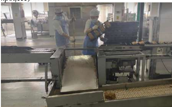
2-р зураг. Үйлдвэрийн гар аргаар талхтай форм зөөх процесс. (нийшингээс гарсан талхыг савлагааны хэсэг рүү явах конвейер шилжүүлнэ мөн цааш хоосон формыг зуурмаг тастах хэсэг рүү өгнө)
