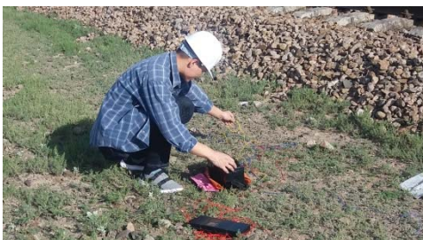
Зураг 3. Газрын гүний хөрсний үе давхаргын тогтоцын судалгаа ба газардуулгын эсэргүүцлийн хэмжилт хийж байгаа байдал
