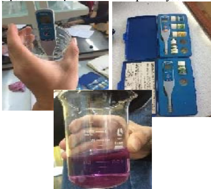
Зураг 6. Хэмжилт хийж хийж буй байдал болон индикаторууд
