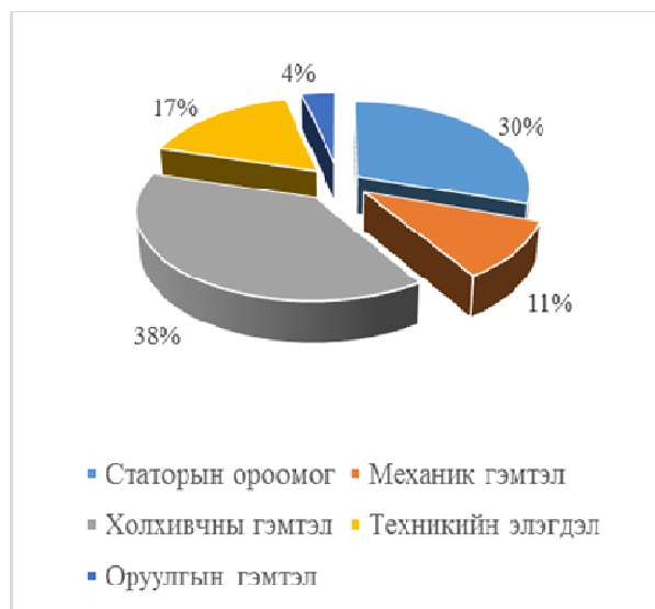
Зураг 1. 0.4 кВ-ын хөдөлгүүрийн гэмтэл (2017 оны байдал)
