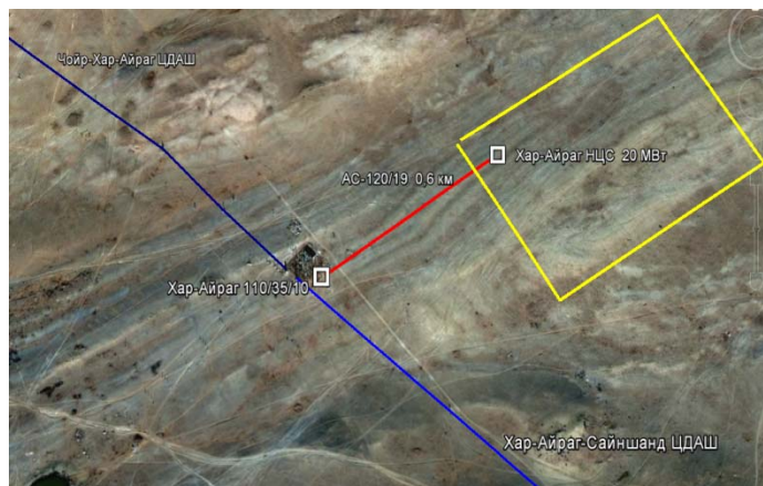
Рис 1. Географическая схема подключения солнечной электростанции к сети
