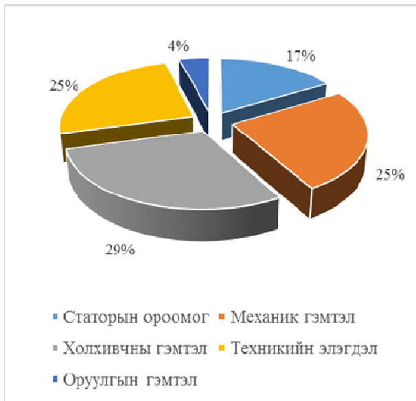
Зураг 2. 6 кВ-ын хөдөлгүүрийн гэмтэл (2017 оны байдал)
