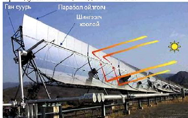
Зураг 3 Парабол ойлгогчтой нарны дулааны цахилгаан станцын ерөнхий схем
