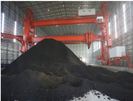
Зураг 3. Нүүрсний талбай, MDQ380/100.38 маркийн хаалга хэлбэрийн шанагат хүрдэн нуруулдан овоологч
