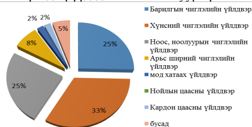
Зураг 2. ДЦС-3 ТӨХК-иас технологийн шаардлагат уур авж байгаа үйлдвэрийн ачааллын судалгааны диаграмм
