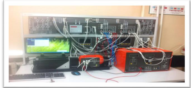
Зураг 2. Компенсацлах төхөөрөмжийг ажиллуулах стэнд
