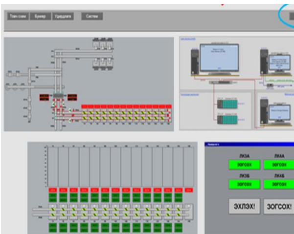
Зураг 4. ДЦС 3-ын түлш дамжуулах цехийн автоматжуулалтанд диспетчерийн ажиллагаа Reliance программ дээр хийгдсэн байдал
