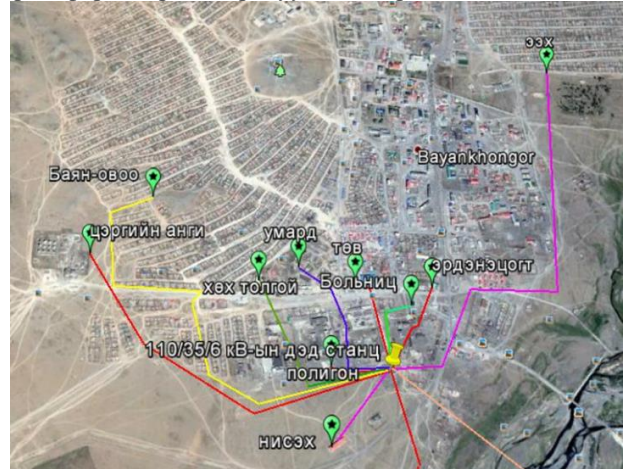
Зураг 1. 6 кВ-ын хүчдэлтэй байх үеийн шугамын трасс
