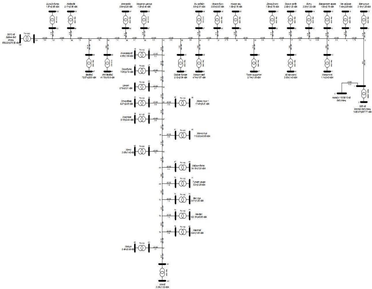
Зураг 1. 35 кВ-ын Элстэй фидерийн зарчмын схем
