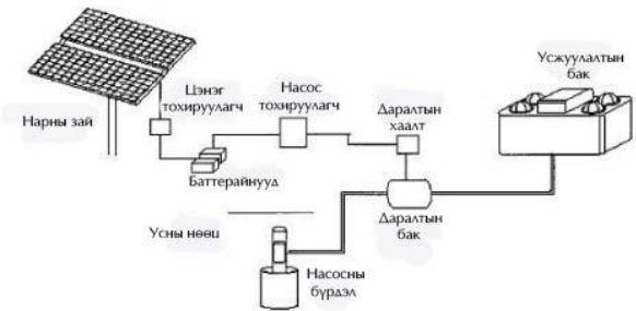
Зураг 4. Баттерей байгууламжтай ус шахах системийн схем
